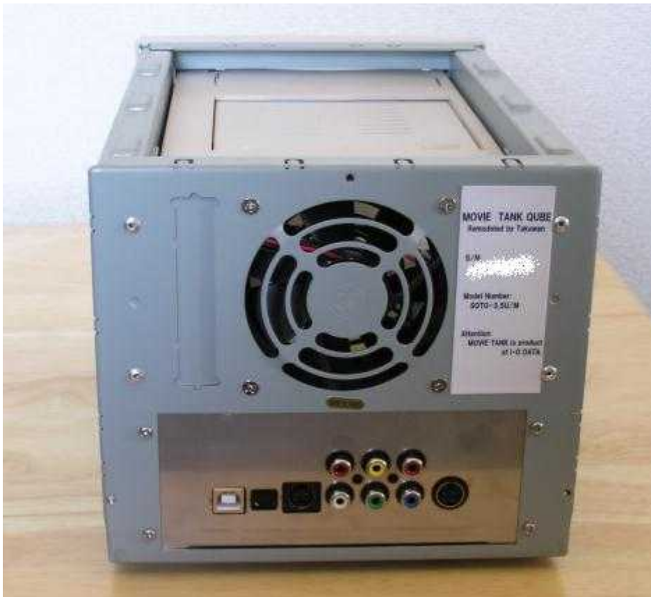
図8～10 ドライブ類をケースに組込んだ状態 図10 ラベルを貼っていますが、実は穴隠しです。
