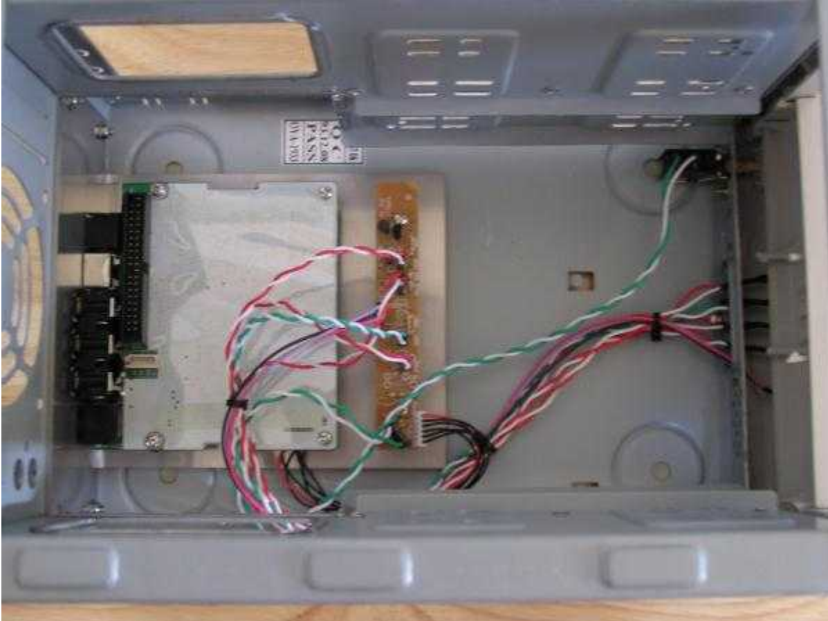
図7 基板をケースに組込んで、LED等を配線した状態です。
