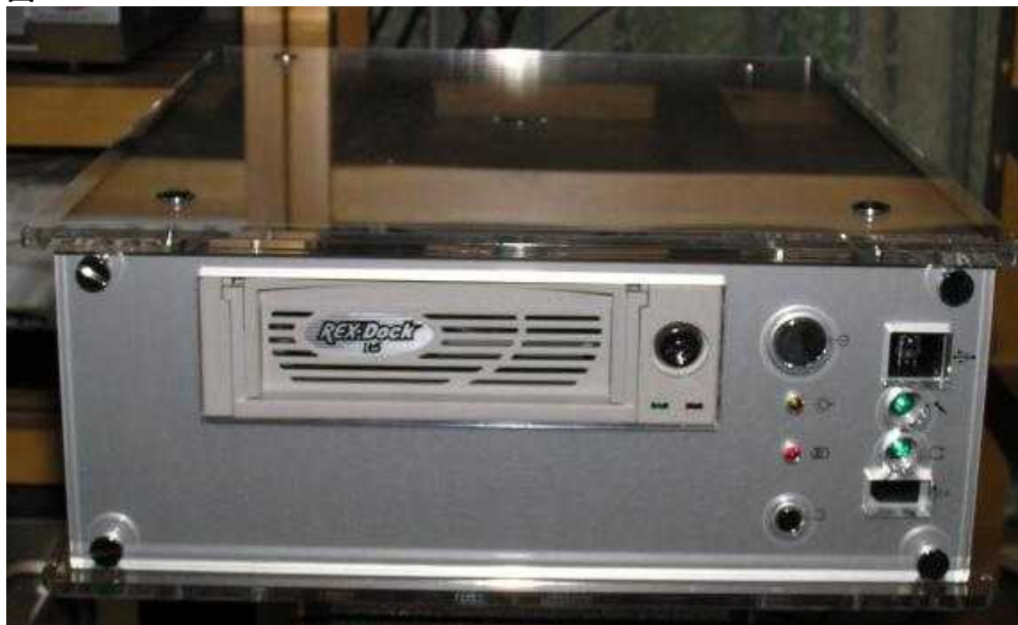
フロントパネル 右側にあったUSB、オーディオ端子部分を利用して リモコン受光部、モード表示用LEDを追加しています。
