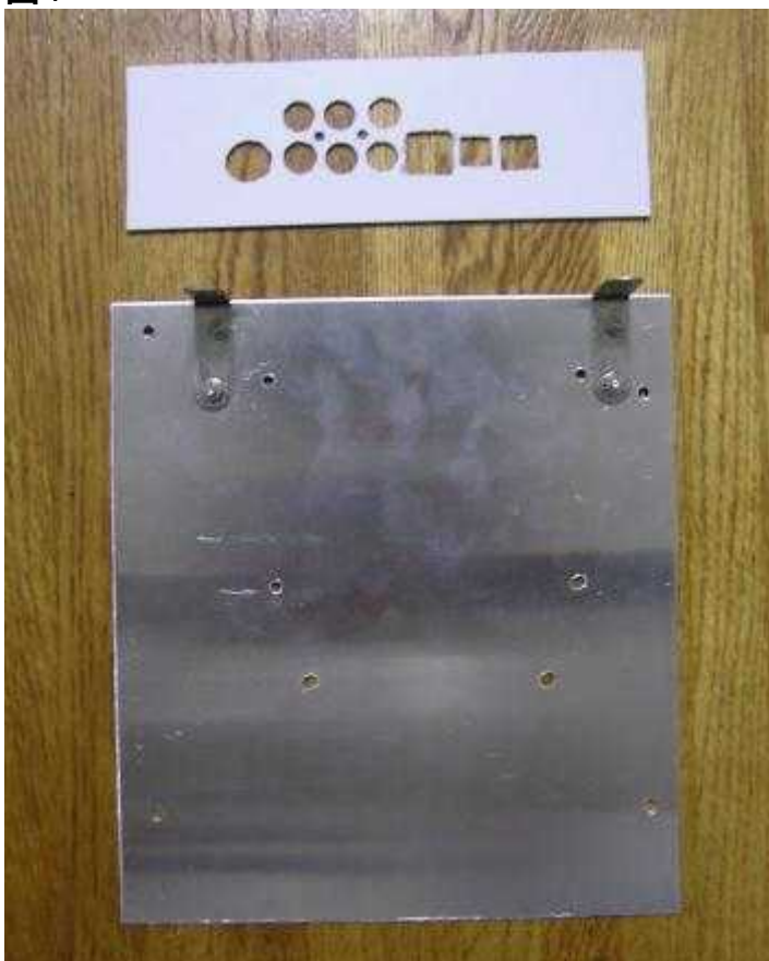
基板を取付けるアルミベースとリアパネルです。(自作)
