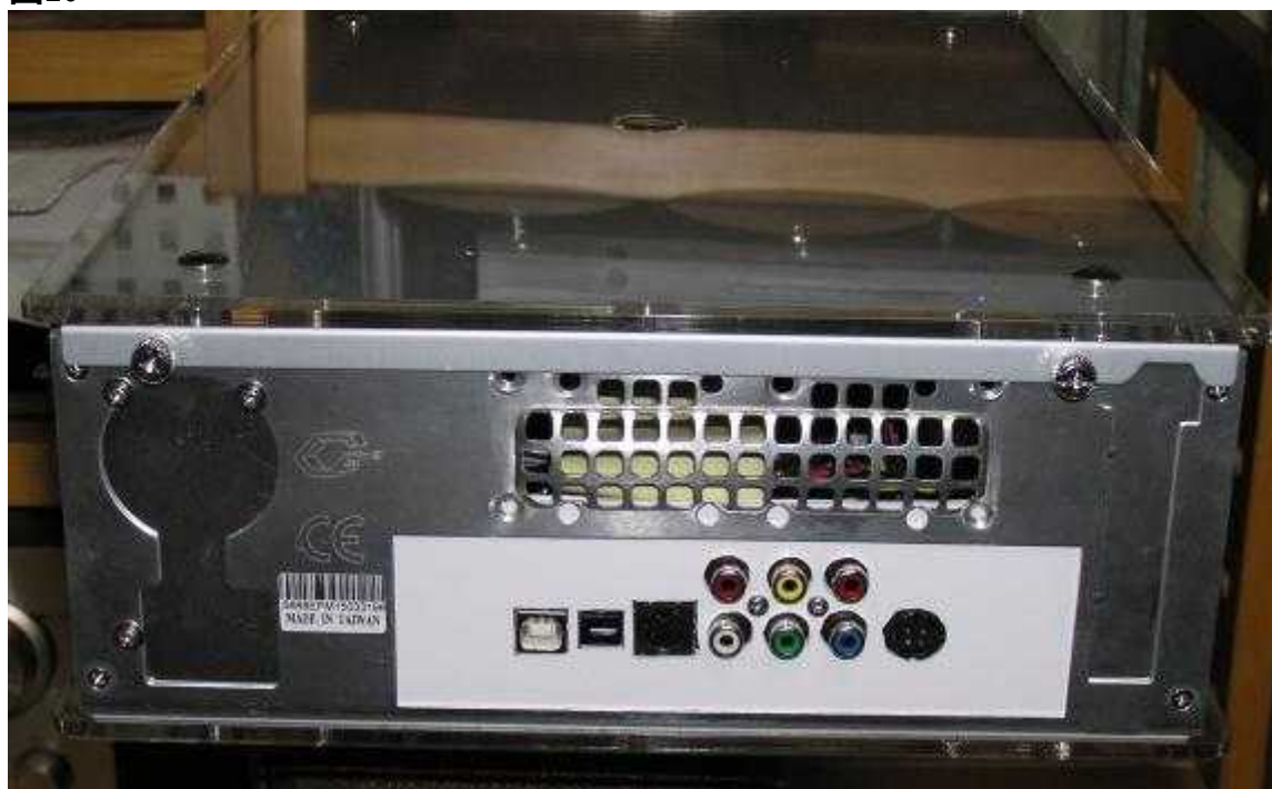
リアパネル 電源部分はアルミ板を取付け、端子部はプラスチック板を 使用しています。(端子部の穴位置を決めるのは大変でした)
